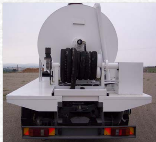
Αντλία γερμανικής προέλευσης και καρούλι με λάστιχο τροφοδοσίας ασβεστοπολτού 40 μέτρων
